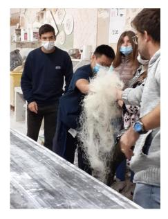
Il nous propose de réaliser un moulage, nous préparons le plâtre, d'abord il faut mettre l'eau puis saupoudrer le plâtre, jusqu'à ce que l'eau soit à fleur et progressivement mélanger.
