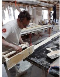
Le plâtre devient chaud lorsqu'il commence à sécher. Dans des ornements épais, il faut mettre de la **filasse** pour renforcer le plâtre, c'est le nom commun donné aux fibres végétales **(sisal, jute, chanvre).**
