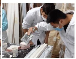
Le staffeur fabrique avec du fil de fer des attaches que nous intégrerons dans les moulages.
