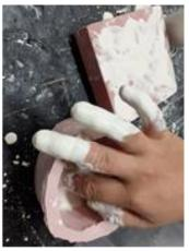
Nous remplissons les moules à ras bord, certains ont dû mettre de la filasse pour servir d'armature dans leur moule. Le morceau de fillasse imbibé de plâtre que tient le staffeur sert à coller aussi les ornements et peut supporter un poids de 80kg.
